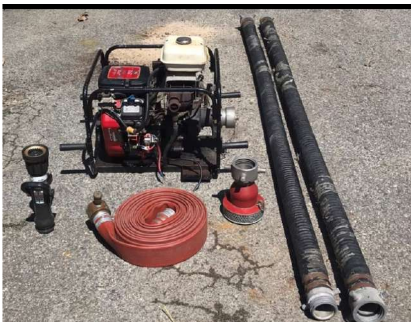
เครื่องสูบน้ำดับเพลิง ชนิดหามเคลื่อนที่ได้ ขนาด ๓๕ แรงม้า จำนวน ๑ เครื่อง
